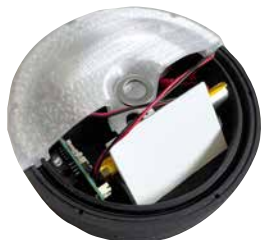
Vista interna dell'anodo elettronico / Internal view of the electronic anode
