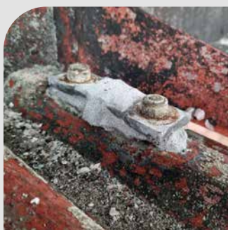
Vecchia tecnologia: l'anodo si degrada, riducendo la protezione.
